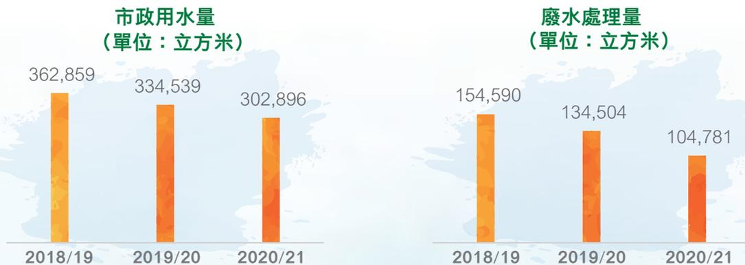
本集團工廠實行「雨污分流」，廠區內生活污水經公共污水管網轉移至公共污水廠房進行處理，排水水質符合中華人民共和國國家標準GB/T 31962-2015《污水排入城鎮下水道水質標準》之要求；較潔淨的雨水則經由市政雨水渠排放。生產用水經由廠內廢水處理中心進行處理，通過反滲透過濾，最終回用至生產過程，實現工業廢水「零排放」。
